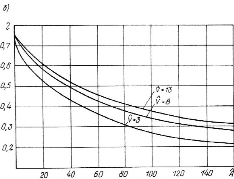
Зависимость сезонного (a) и годового (b) КПД установки солнечного горячего водоснабжения от величин  $\hat{A}$  и  $\hat{V}$
