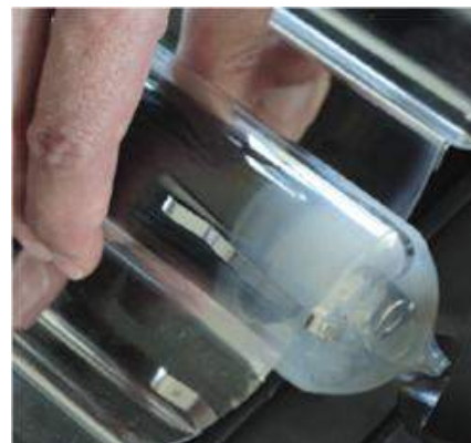
газопоглотитель разрушен, трубка неисправная
