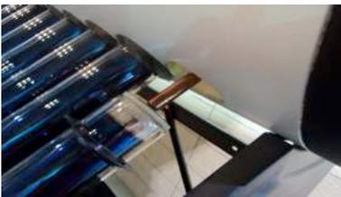
Осторожно вставьте трубу в бак, медленно и мягко, чтобы не повредить трубу, поворачивайте ее в направлении по часовой стрелке, держа вакуумную трубку за среднюю и нижнюю часть до проникновения медного наконечника в бак. После этого установите черное силиконовое уплотнительное кольцо в место соединения трубки с баком.
