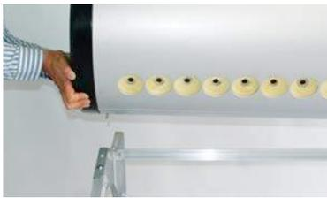
После того, как конструкция рамы будет жестко закреплена, снимайте гайки с нижней части бака для воды и установите его наверху рамы. Затем поставьте гайки на место, постепенно затягивая их в нижней части водонагревателя. Полностью затянуть гайки нужно будет после установки вакуумных трубок на раму.
