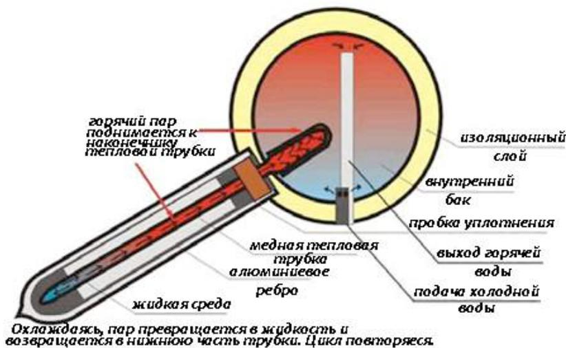
Охлаждаясь, пар превращается в жидкость и возвращается в нижнюю часть трубки. Цикл повторяется.
