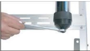
Когда вакуумная трубка будет установлена в бак, в пластиковое кольцо, установленное в нижней части рамы, завинтите поддерживающую трубку черную пластиковую чашечку.
