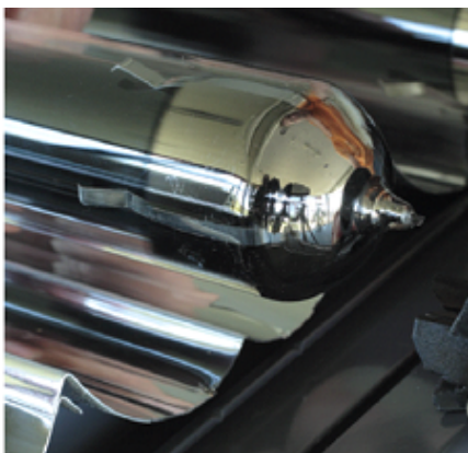
газопоглотитель в порядке, трубка исправная ←
