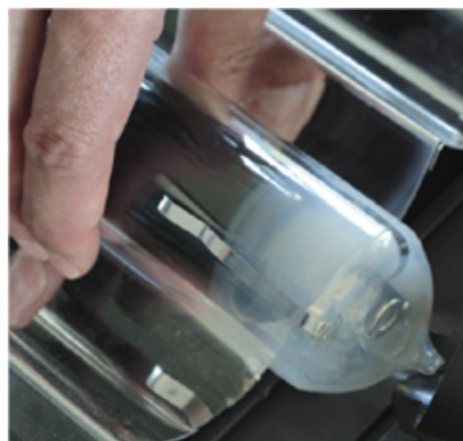
→ газопоглотитель разрушен, трубка неисправная
